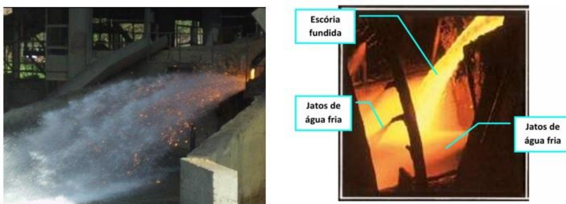
Figura 3.2.A – Resfriamento de EAF com jatos de água sob alta pressão
