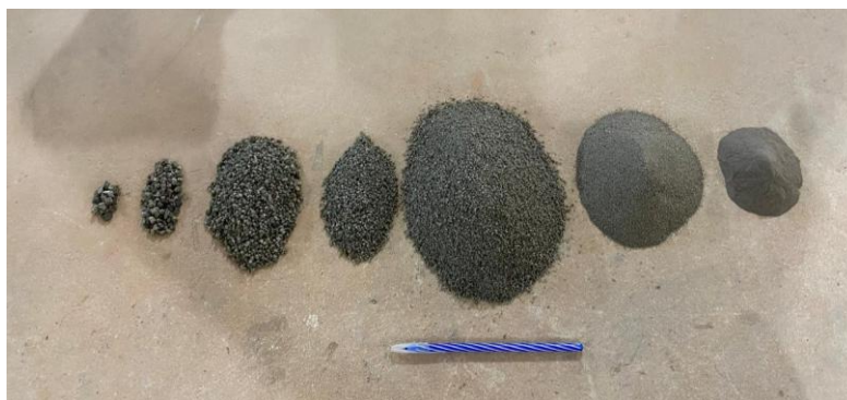
Figura 3.3.1.1.B – Ensaio para composição granulométrica da EAF “in natura”
