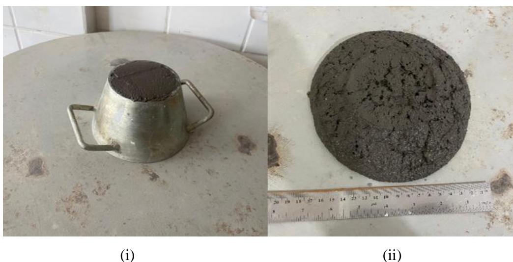
Figura 3.3.1.1.C – Ensaio do índice de consistência na amostra de EAF beneficiada (i) argamassa moldada no tronco cônico (ii) argamassa analisada após golpes
