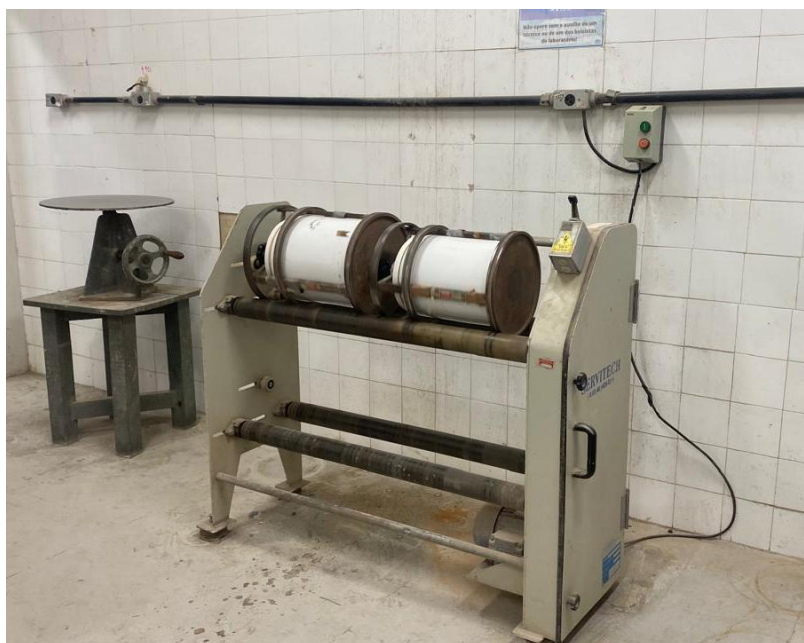
Figura 3.3.C – Equipamento moinho de bolas pertencente ao laboratório LEMAC/UFPA
